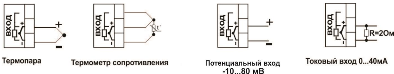
Рисунок 17 – Схема подключения датчиков температуры
