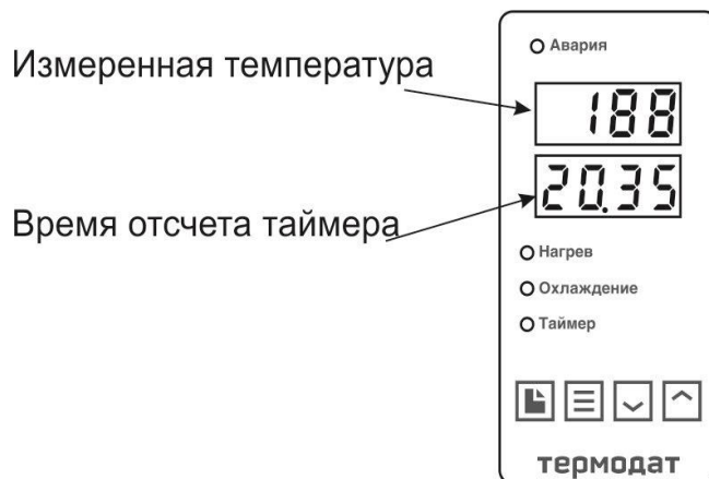
Рисунок 15 – Описание индикаторов при настройке таймера Термодат-10К7-В
