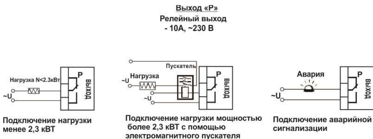
Рисунок 18 – Схемы подключения релейных выходов.
