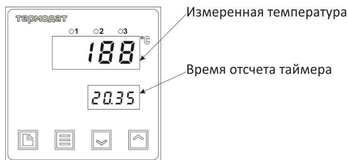
Рисунок 13 – Описание индикаторов при настройке таймера Термодат-10К7-М
