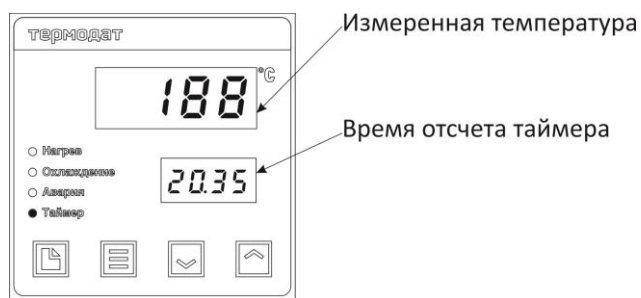
Рисунок 12 – Описание индикаторов при настройке таймера Термодат-10К7-А
