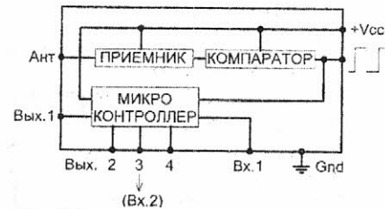
Рис.2 Структурная схема приемника
