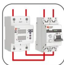
Подключение нагрузки до 14 кВА
