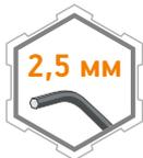
Использовать шестигранный ключ размером 2,5 мм для затяжки соединения
