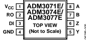
Figure 5. ADM3071E/ADM3074E/ADM3077E Pin Configuration
