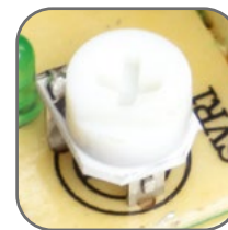
Возможность корректировки выходного напряжения
