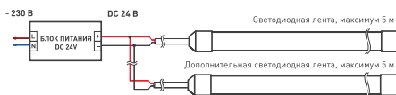
Рисунок 2. Схема подключения лент к источнику питания при температуре окружающей среды более +40 °C
