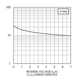
CAPACITANCE BETWEEN TERMINALS:C<sub>t</sub>(pF)
