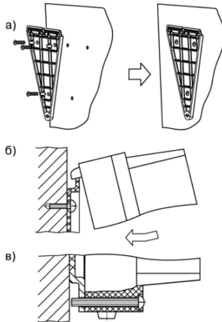
Рисунок 4.1 – Монтаж прибора
