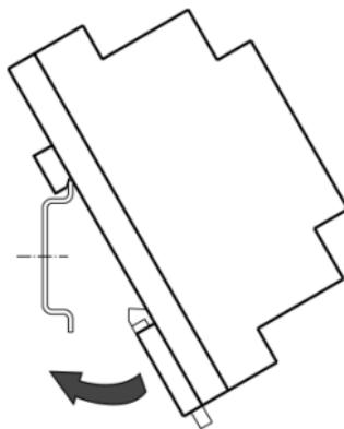
Рисунок 4.3 - Монтаж прибора с креплением на DIN-рейку
