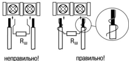
**Рисунок 4.4 – подключение шунтирующего резистора**
