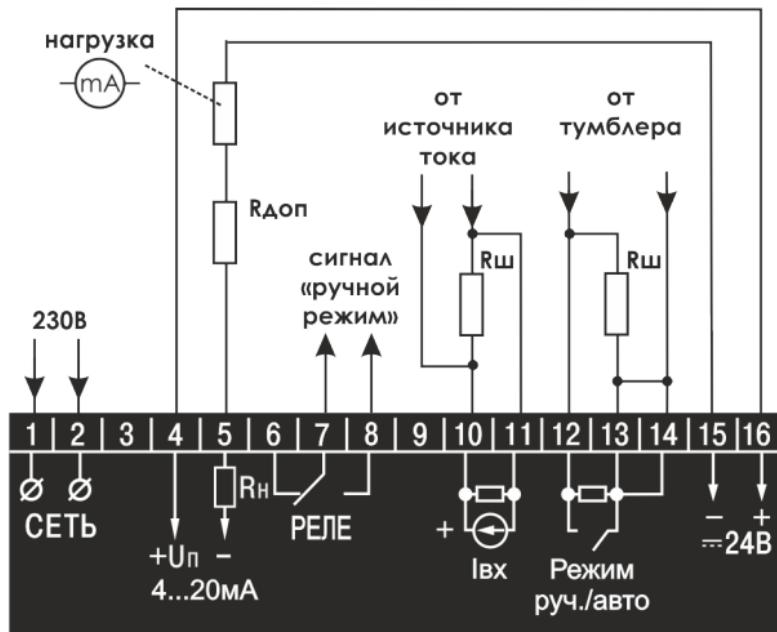
Рисунок Б.1 - Подключение УЗС-1.x.И
