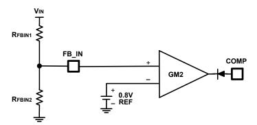
Figure 44. V<sub>IN</sub> Feedback Loop
