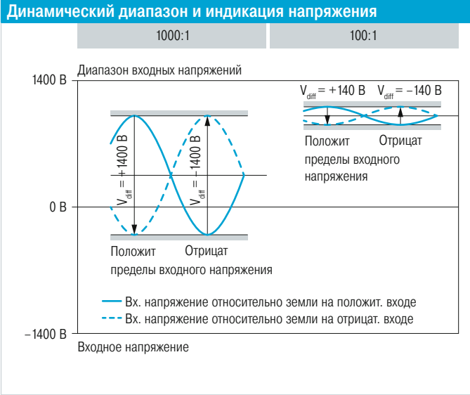
Дифференциальный высоковольтный пробник R&S®RT-ZD01: безопасные измерения вплоть до категории CAT III
