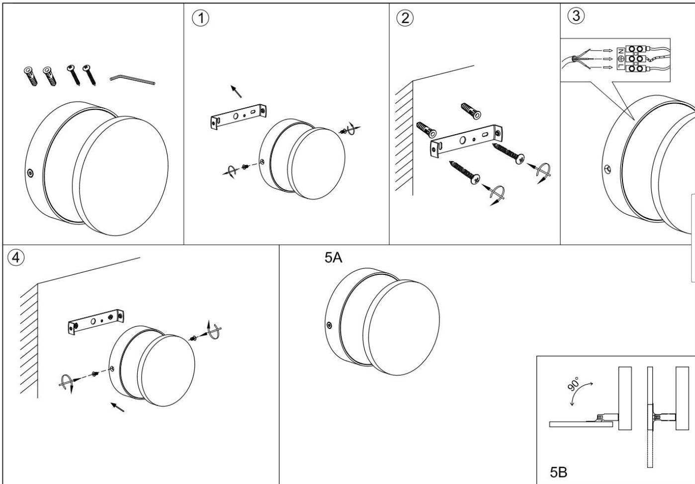
1. Подготовьте светильник к установке открутив винты фиксации и пластины крепления в основании светильника.
