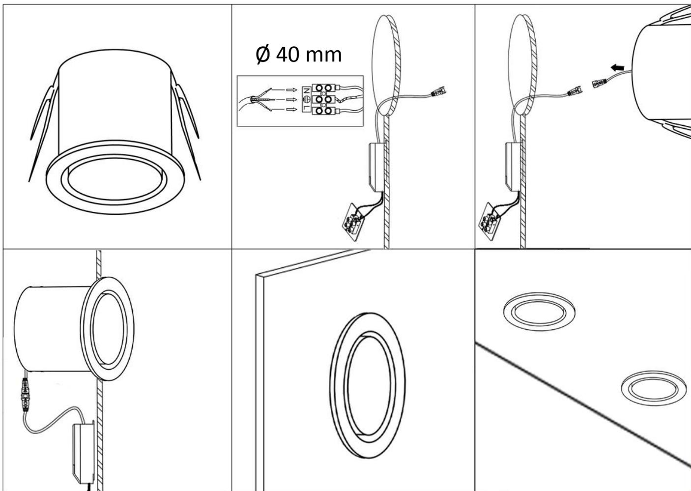
1. Просверлите врезное отверстие на поверхности согласно установочным размерам светильника.
