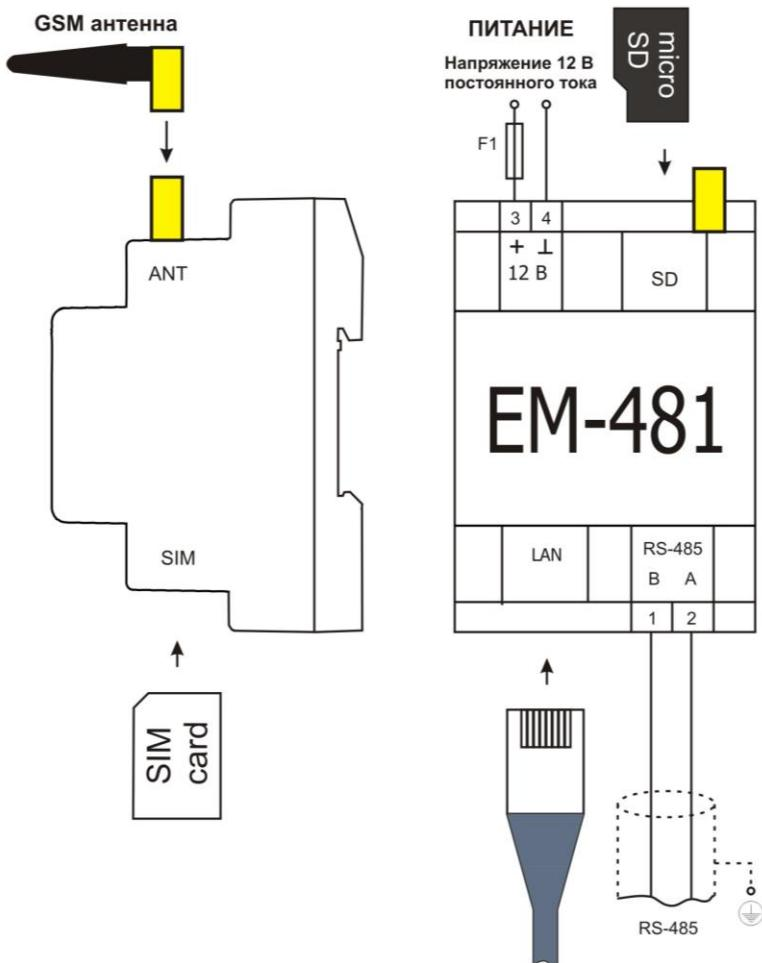
F1 – предохранитель (вставка плавкая)
