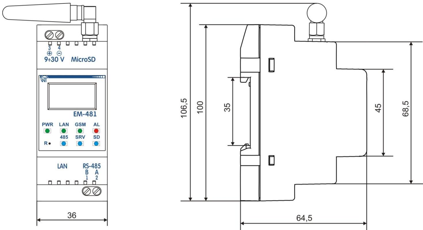
Рисунок 1.1 – Габаритные и установочные размеры EM-481
