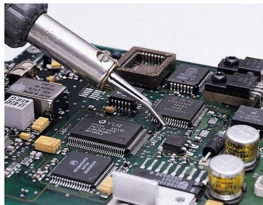
*Монтаж SMD - корпусов с помощью наконечника "миниволна"*
