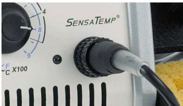
Система точного поддержания температуры SensaTemp, запатентованная компанией PACE, по сей день остается лучшим техническим решением среди классических схем термоуправления. Сердцем системы является платиновый термодатчик RTD-типа (Resistant Temperature Detector), точность которого в 5 раз превышает точность традиционной термопары.
