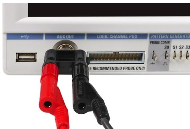
**Рисунок 6-14 – Адаптер BNC/банан, подключенный к разъему AUX OUT**
