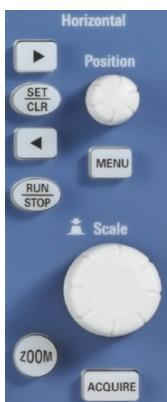
1. Для выбора масштаба по оси времени (масштаба по горизонтальной оси), можно использовать поворотную ручку SCALE в области Horizontal. Текущие настройки временной шкалы, например, "TB: 500 ns", отображаются в верхнем левом углу над сеткой. При стандартных настройках точка запуска располагается по центру экрана, при этом 50% сигнала отображается до и 50% сигнала отображается после позиции запуска.
