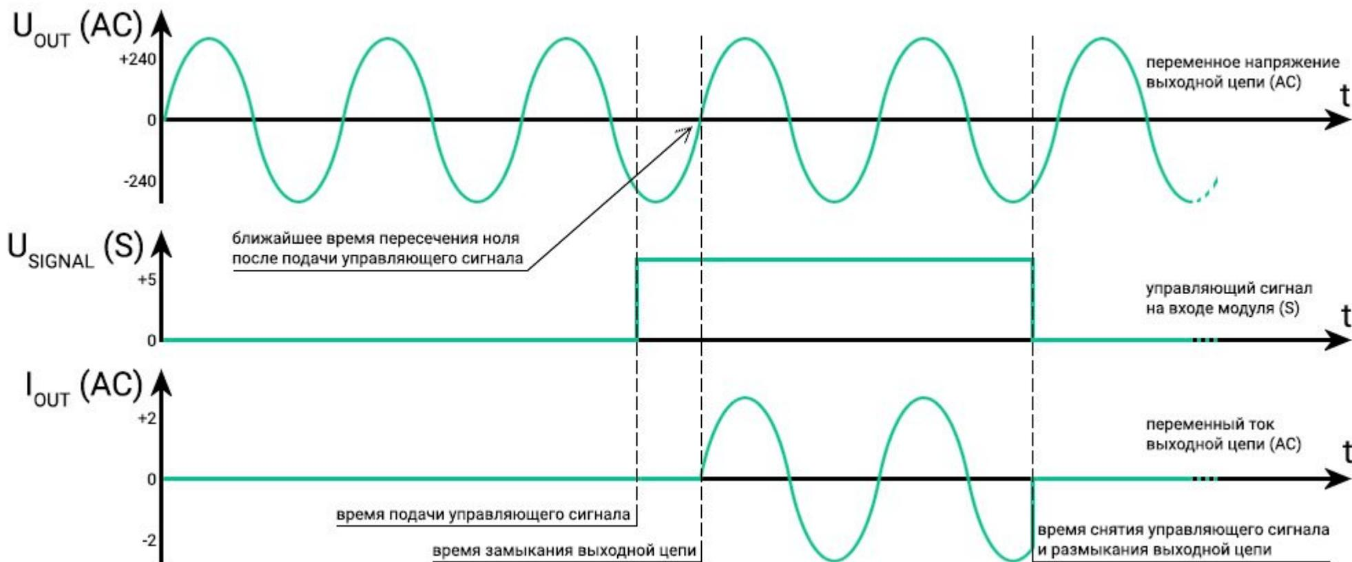
Из графика видно, что после подачи управляющего сигнала на вход модуля, реле ожидает когда приложенное к выходной цепи напряжение "пересечёт" ноль и только в этот момент замыкает выходную цепь. Следовательно в выходной цепи не происходит резкого увеличение тока.
