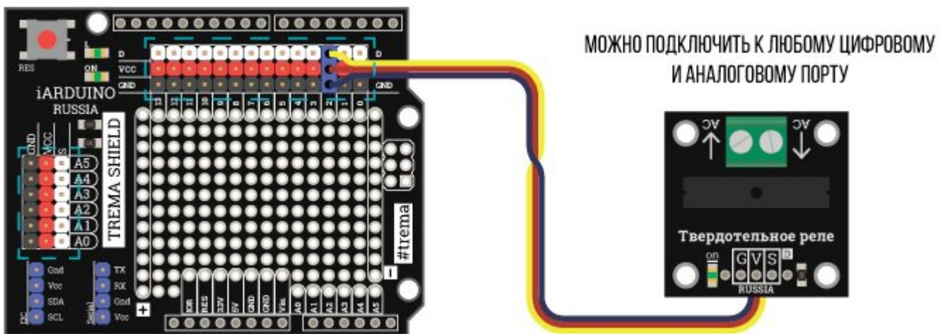
Выход (AC) модуля (клеммник) подключается в разрыв фазы силовой цепи переменного тока.
