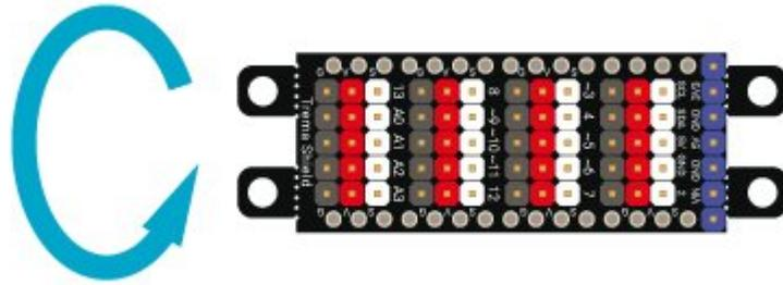
Установите Arduino NANO на Trema Shield NANO Compact.
