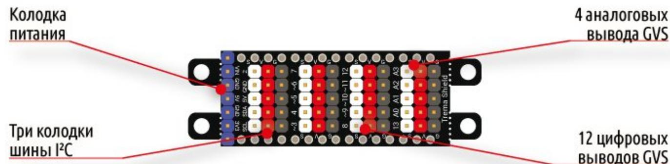
На плате Trema Shield NANO Compact возле каждого информационного вывода находятся два вывода питания (V)-Vcc и (G)-GND, значит количество подключённых модулей без пайки и «скрутки» проводов, может совпадать с количеством информационных выводов [Arduino NANO](#).
