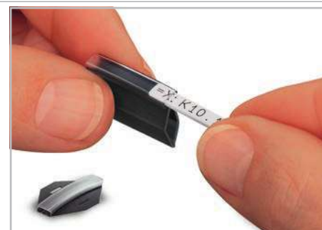
Вставьте напечатанный маркер в держатель маркировочной манжеты. Замена маркера возможна и после подключения проводника.
