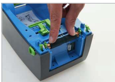
Вставьте и зафиксируйте подходящий валик в принтере.
