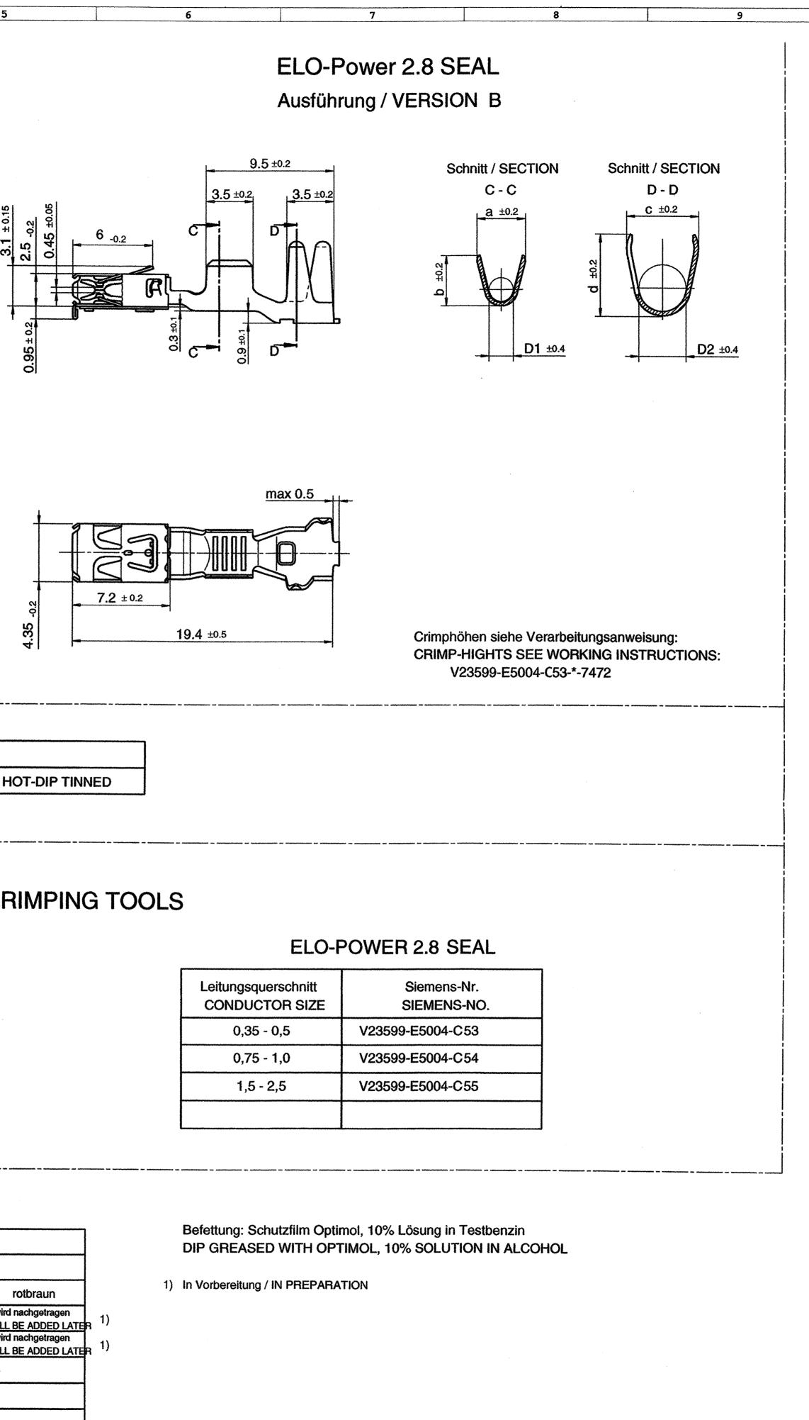
\*) Längen und Winkel: DIN7168-m Form und Lage: DIN ISO 2768-mH LENGTH AND ANGLES: DIN7168-m FORM AND POSITION: DIN ISO 2768-mH
