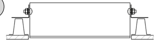
Для облегчения обслуживания светильника (монтаж и демонтаж рассеивателя), рекомендуется дополнительно закреплять монтажные пластины на траверс винтами саморезами, при необходимости, просверлив в гребенке (траверсе) отверстия требуемого диаметра.
