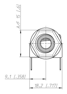
Frontplattenausschnitt (Rückseite) Panel cut out (rear side)
