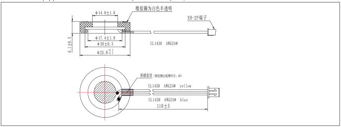
注: UL1430 导线、胶圈、焊锡丝、黄腊管符合环保要求,压电陶瓷体豁免含铅量。
