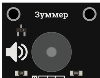
[Trema-модуль зуммер пассивный](#) основан на электромагнитном излучателе, который состоит из кольцевого магнита, сердечника с электромагнитной катушкой и гибкой металлической мембраны. Электромагнитная катушка преобразует электрические колебания в магнитные, а мембрана преобразует магнитные колебания в механические. Полученные механические колебания распространяются по воздуху в виде звуковых волн. Пластиковый корпус, с отверстием, усиливает акустический эффект.
