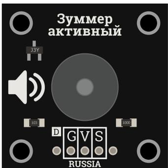
[Trema-модуль зуммер активный](#) состоит из 5В генератора прямоугольных импульсов (меандра) с частотой 2,3 кГц, и электромагнитного излучателя в одном корпусе. Сигнал с генератора подается на электромагнитный излучатель и преобразуется в звуковые волны той же частоты.
