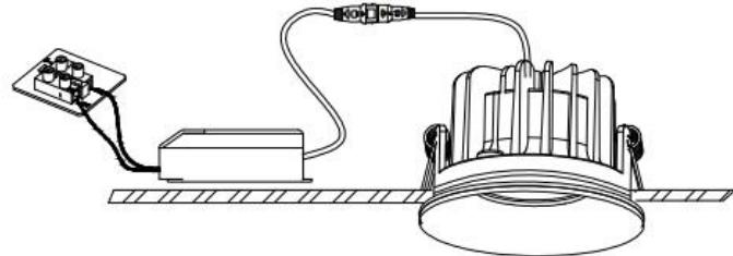
1. Просверлите врезное отверстие в подвесном потолке согласно установочным размерам светильника.
