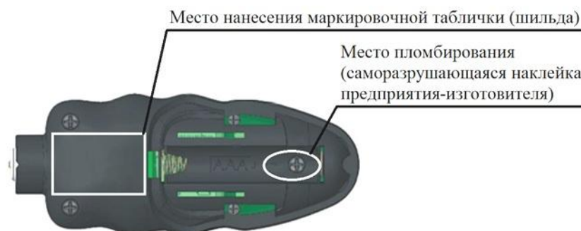
Рисунок 2 – Схема пломбировки от несанкционированного доступа
