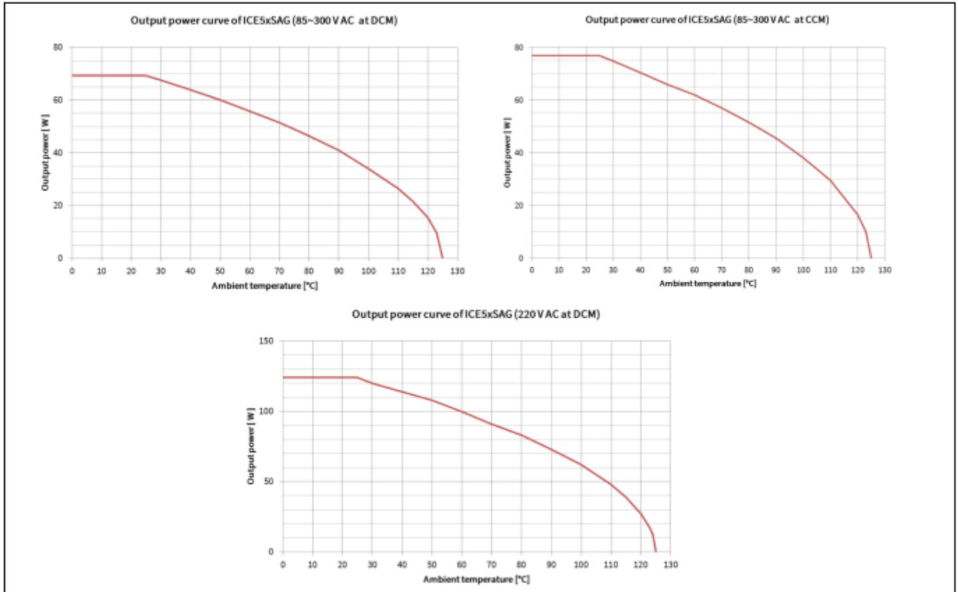
图 17 ICE5xSAG 的输出功率曲线
