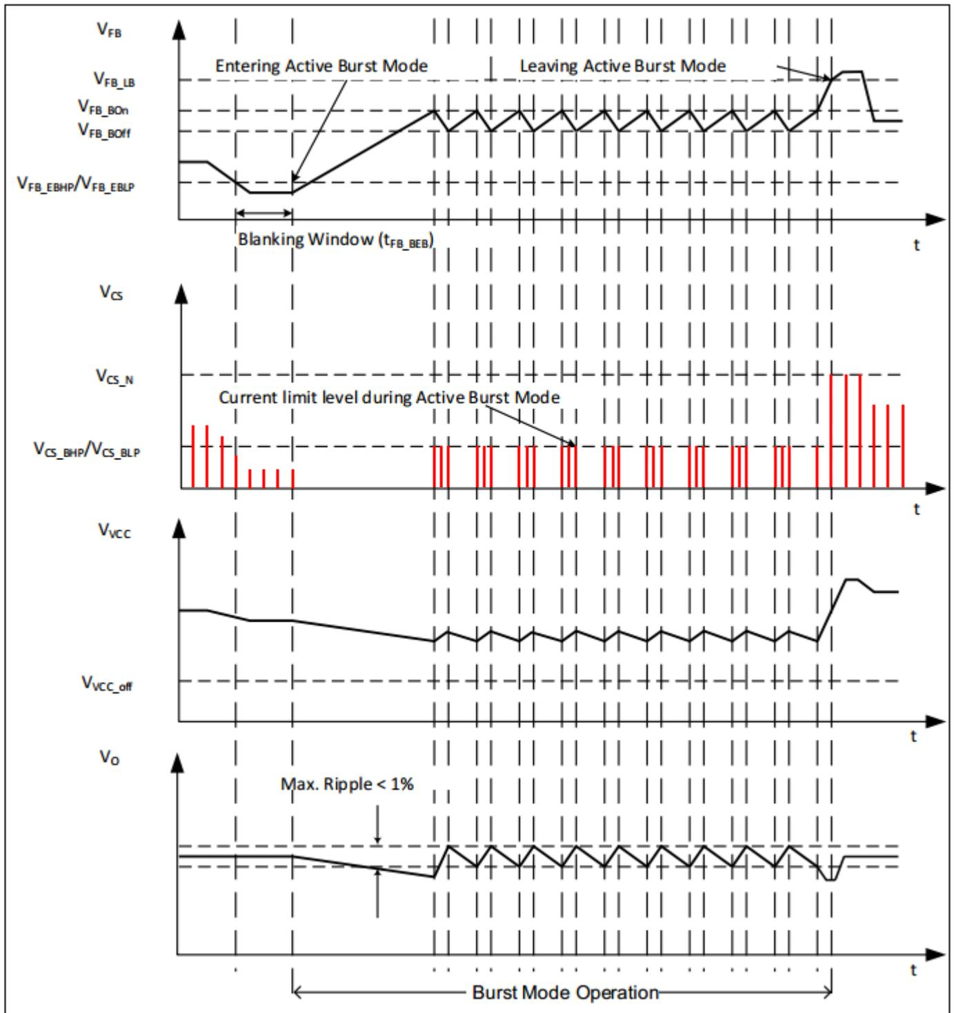
图 12 主动突发模式中的信号
