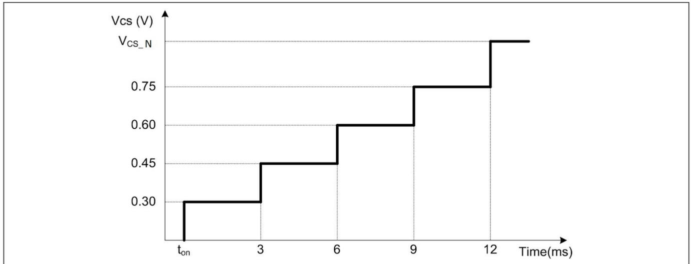
图 6 软启动期间的最高电流感测电压
