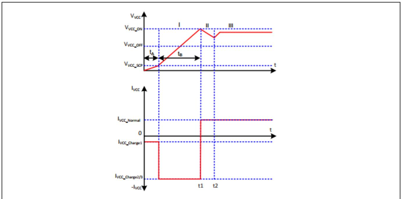
图 5 启动时的 V<sub>CC</sub> 电压和电流
