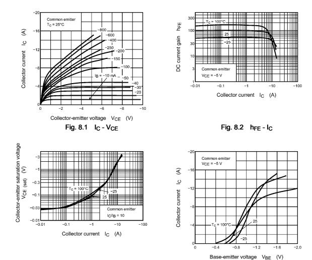
Fig. 8.3 V<sub>CE(sat)</sub> - I<sub>C</sub>
