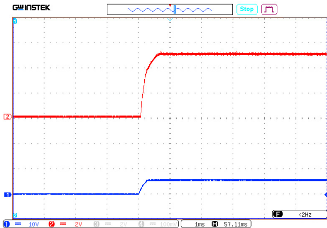
Рис. 10 (а). Осциллограмма установления выходного напряжения с момента подачи команды дистанционного управления.
