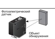
**Датчик с диффузионным отражением**
