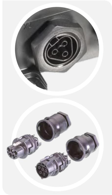
**Односекционные** (неразборные), устанавливаются в отверстие в панели корпуса диаметром 25,4 мм (M25). Пространственно основная часть разъема располагается внутри корпуса, снаружи корпуса располагается только лицевая сторона контактной группы разъема. Фиксация односекционного разъема M25 в панели корпуса обеспечивается удерживающей гайкой, устанавливаемой с наружной стороны корпуса.
