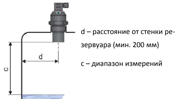
Рис. 3: Расстояние между уровнемером и стенкой резервуара
