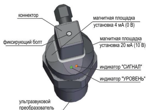
Рис. 29-1: Управление уровнемером магнитным стилусом
