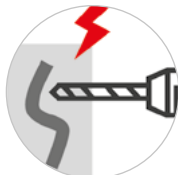
Механическое повреждение изоляции
