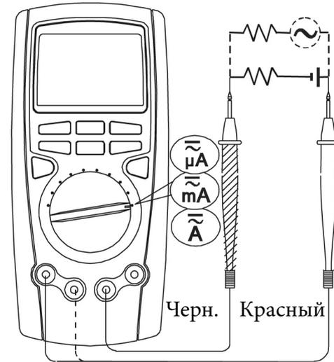
Рис. 3-2. Измерения электрического тока
