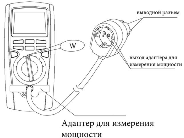
Рис 3-9. Измерения мощности
