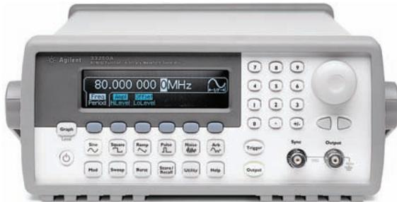
Agilent Technologies 33250A – генератор сигналов стандартной формы с частотой выходного сигнала до 80 МГц, возможностью генерации импульсного сигнала и сигналов произвольной формы. Генератор построен на основе прямого цифрового синтеза формы колебаний. Сочетание свойств автономного и системного прибора делает этот генератор универсальным средством для удовлетворения требований к испытаниям в настоящее время и в будущем.
