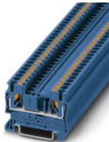
Durchgangsklemme, Nennspannung: 800 V, Nennstrom: 24 A, Anschlussart: Push-in-Anschluss, Anzahl der Anschlüsse: 2, Polzahl: 1, Querschnitt: 0,14 mm<sup>2</sup> - 4 mm<sup>2</sup>, AWG: 26 - 12, Breite: 5,2 mm, Höhe: 35,3 mm, Farbe: blau, Montageart: NS 35/7,5, NS 35/15
