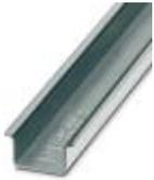
Tragschiene ungelocht, Standardprofil, Breite: 35 mm, Höhe: 15 mm, ähnlich EN 60715, Material: Stahl, verzinkt, weißpassiviert, Länge: 2000 mm, Farbe: silberfarben
