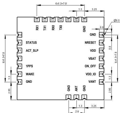
Рис. 4. Чертеж контактных площадок
