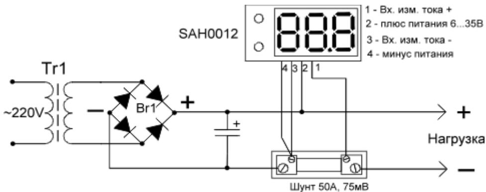
Схема включения с использованием отдельных источников питания для питания модуля и для нагрузки на которой измеряется ток
