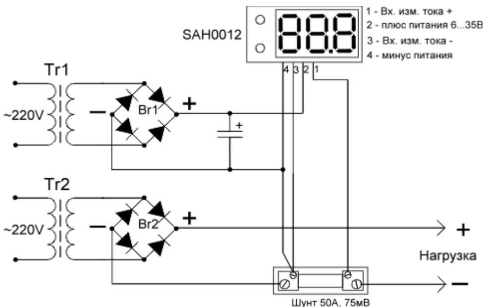
Схема включения в разрыв плюсового провода
