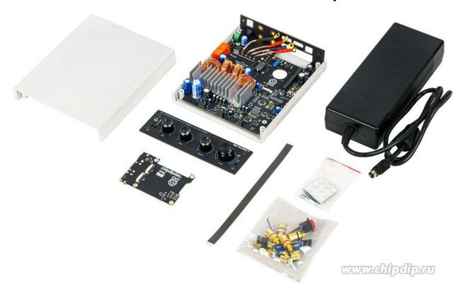
**DSP machine 1 Max Power Amp 234** - стример, цифроаналоговый преобразователь ЦАП, аудиопроцессор, усилитель для микрокомпьютеров Raspberry Pi 2,3,4 (в комплект не входят). Передняя панель черная
