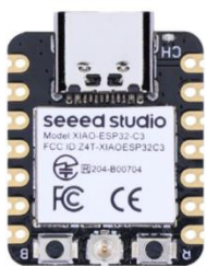
AI-модуль на базе Seed Studio XIAO ESP32C3
