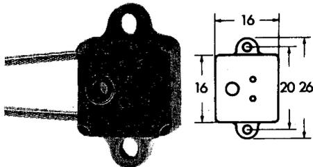
Corpo isolante in steatite - Protezione in mica - Contatti in nichel puro - Conduttori saldati elettricamente - Cavetto sez. 0,75 mm<sup>2</sup> - Lunghezza standard cm. 12,5 - Fissaggio a mezzo fori per il passaggio di viti M3.
