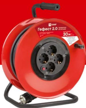
Удлинитель на металлической катушке «Гефест 2.0» EKF PROxima могут использоваться на строительных площадках, для подключения энергоемких потребителей в гаражах и на приусадебных участках, в том числе сварочной аппаратуры, перфораторов, электропил. Надежный кабель КГ в резиновой изоляции выдержит как механические нагрузки, так и суммарную мощность подключенных потребителей до 3,5 кВт.
