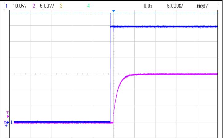
蓝色通道：输入电压波形，10V/格；紫色通道：输出电压波形：5V/格；秒格：5mS/格。
