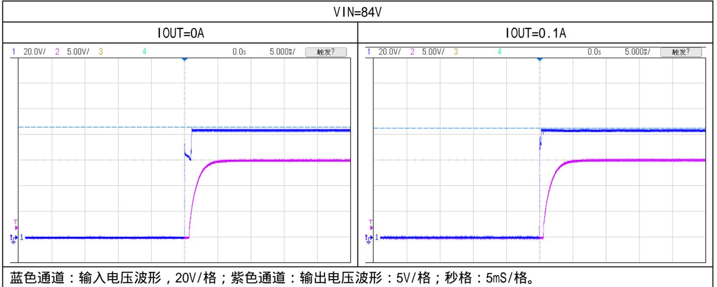
短路撤销后输出电压波形：
