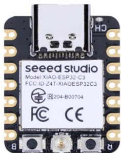
AI-модуль на базе Seeed Studio XIAO ESP32C3
