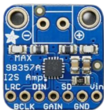
Усилитель класса D i2s MAX98357A
