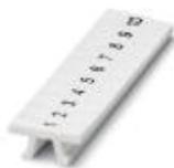
Zackband, Streifen, weiß, beschriftet, längs bedruckt: fortlaufende Zahlen, 1-10, 11-20 usw. bis 91-100, Montageart: verrasten in hoher Schildchennut, für Klemmenbreite: 3,5 mm, Schriftfeldgröße: 3,5 x 10,5 mm
