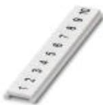
Zackband flach, Streifen, weiß, beschriftet, längs bedruckt: fortlaufende Zahlen 1 ... 10, 11 ... 20 usw. bis 91 ... 100, Montageart: verrasten in flacher Schildchennut, für Klemmenbreite: 3,5 mm, Schriftfeldgröße: 5,15 x 3,5 mm
