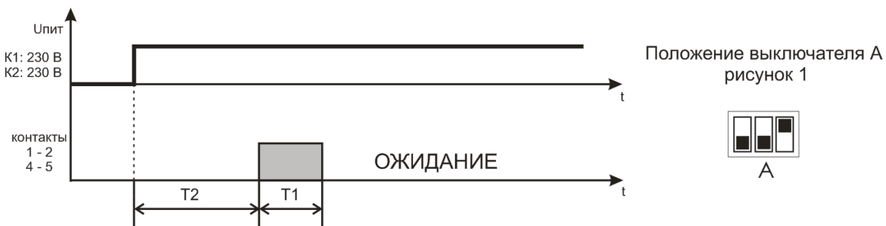
Рисунок 3 – Алгоритм работы реле “Импульсный 1”
