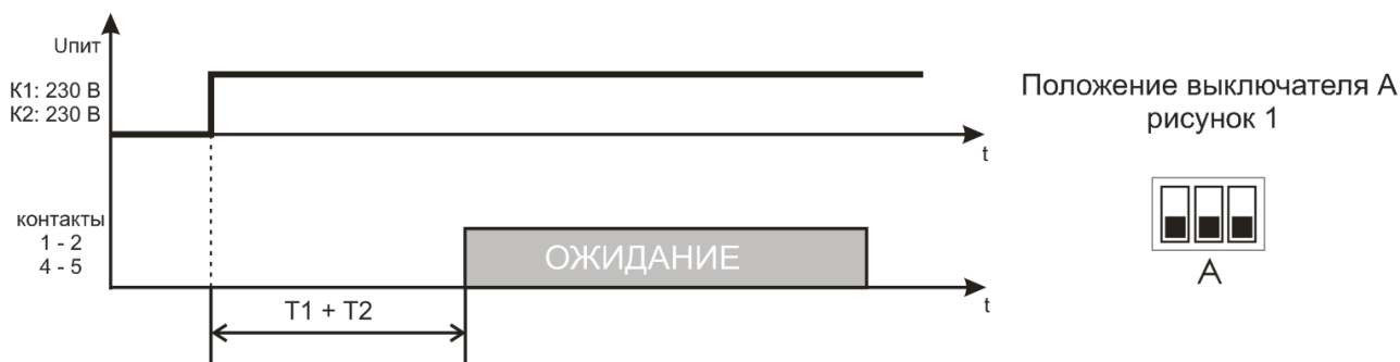
Рисунок 2 – Алгоритм работы реле “Задержка на включение”
