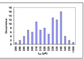
**FIGURE 2-17:**  $I_{DD}$  Histogram ( $V_{DD} = 5.0V$ ).
