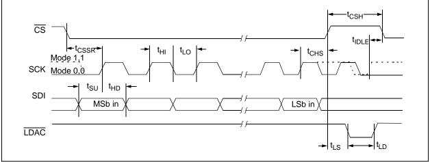
FIGURE 1-1: SPI Input Timing Data.
