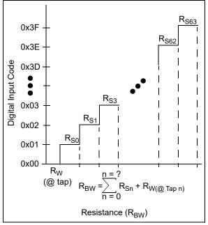
FIGURE B-4: THEORETICAL R<sub>BW</sub> OUTPUT VS CODE (MONOTONIC OPERATION).
