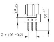
Elastische Einpresszone / campliant pressfit zane Isolierwerkstoff / hausing material : PBT GF30
