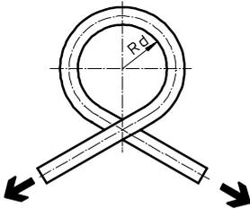
Der Schlauch wird in Richtung seiner Eigenkrümmung gebogen bis eine Abflachung von 5% des Schlauchaußen- $\varnothing$  eintritt. Danach wird  $R_d$  rechnerisch ermittelt. Eine Durchflussreduzierung findet bis Erreichen von  $R_d$  nicht statt.
